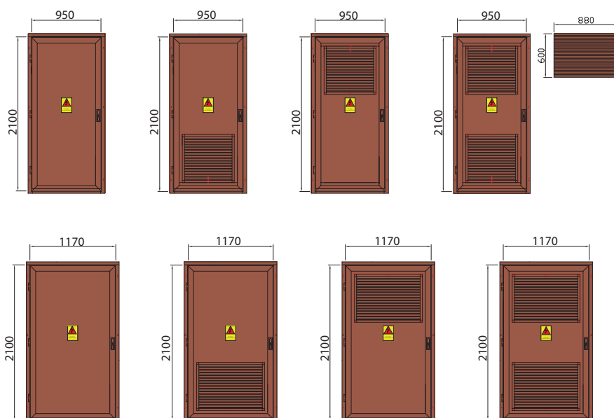
Zastosowanie w stacjach KSW 296/... o wysokości korpusu 2970 mm
