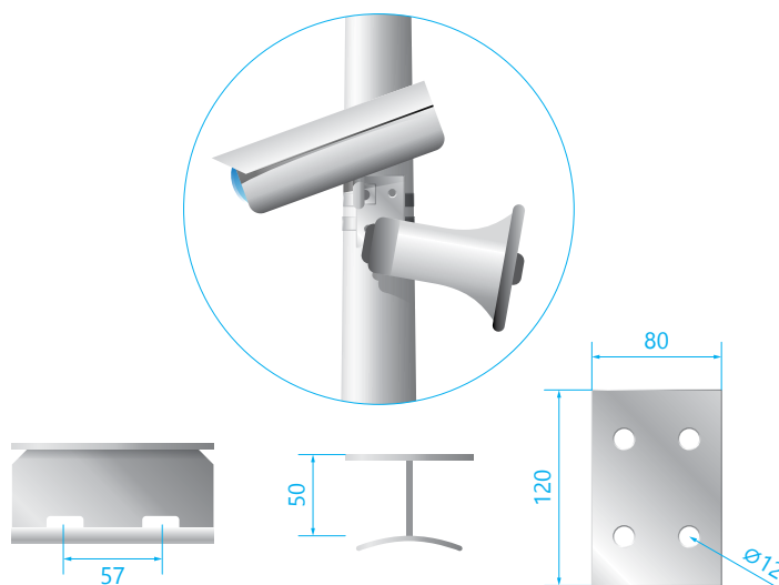
UCHWYT INSTALOWANY DO SŁUPA ZA POMOCĄ TAŚM MONTAŻOWYCH COT 37.
