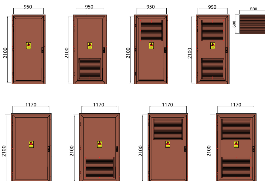
Zastosowanie w stacjach KSW 296/... o wysokořci korpusu 2970 mm
